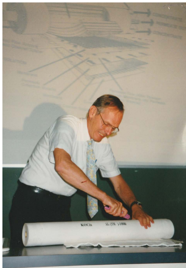
Kuva 3 "The Eykamp Cut" – käytetyn spiraalimoduulin avaus. "Patologina" Dr Bill Eykamp.
