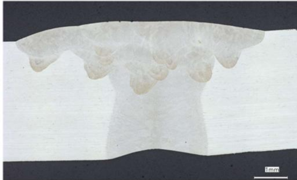
Inconel 625 -materiaalin laserhitsaus.
