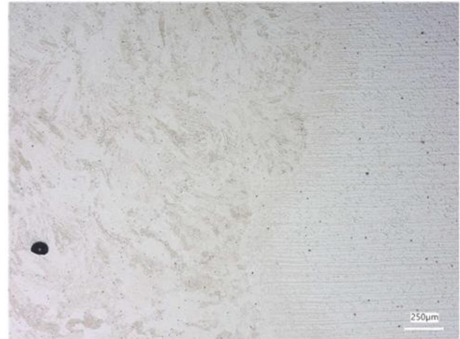
Kuva 20. Käsilaserhitsatun hiiliteräksen mikrorakenne: vasemmalla lisäaine, keskellä n. 0,2 mm leveä HAZ, oikealla perusmateriaali (Apollo Machine, Canada).
