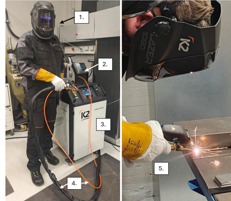
Käsilaserhitsausvarustus: 1. EN 207:2017 mukainen henkilökohtainen suojavarustus, 2. Langansyöttölaite, 3. Laserlähde ja käyttöliittymä, 4. Valokuitu, suojakaasu- ja lisäainejohtimet, 5. Hitsauspoltin ja pienahitsaus kontrolloidulla laserkäyttöalueella
