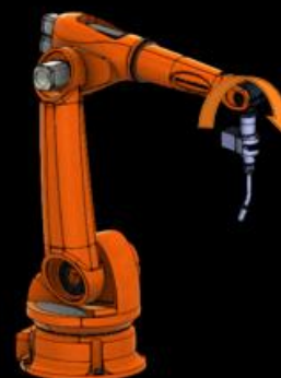
5-akseli Liikuttaa robotin rannetta ylös ja alas
