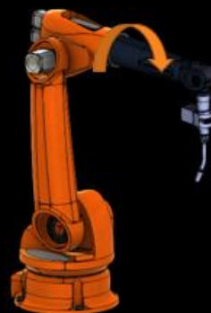
4-akseli Pyörittää robotin käsivartta
