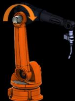
3-akseli Liikuttaa Ylös ja alas robotin käsivartta
