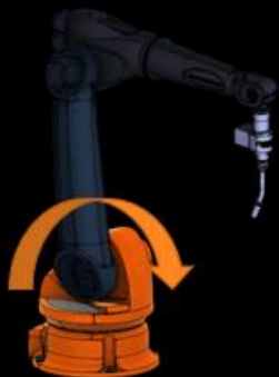
2-akseli Liikuttaa edestakaisin robotin käsivartta
